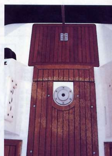
La schiena d'asino può essere asportata, per alleggerire l'estremità e per accedere allo spoiler attrezzato.
