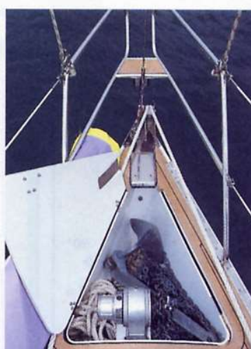
Il verricello dell'ancora è interno al gavone. Il pulpito aperto facilita la discesa dalla barca.
