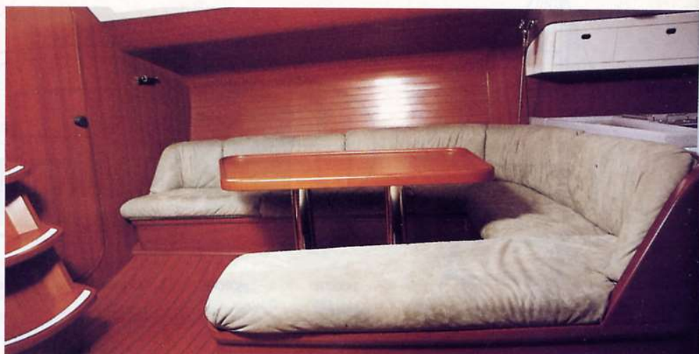
Questa immagine evidenzia la singolare disposizione della dinette, posta subito ai piedi della scala d'ingresso. Il livello delle finiture è molto elevato, con una scelta accurata della venatura del mogano e largo uso di pannelli a sandwich, per alleggerire il più possibile il mobilio. La tappezzeria è in alcantara.
