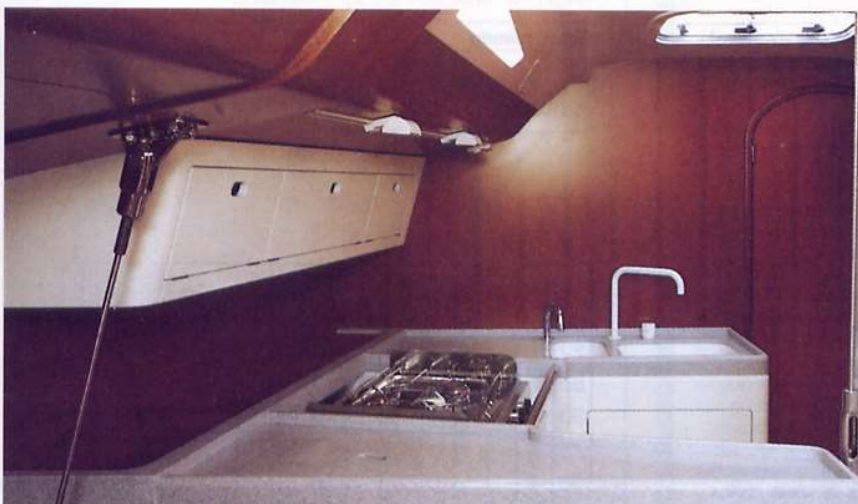
La cucina si sviluppa a pruvavia dell'albero e presenta due parti operative contrapposte: quella inquadrata include fornelli e lavabo, sull'altro lato c'è il frigo ed altri pensili. In navigazione questa zona risente del beccheggio. La ventilazione è assicurata dal boccaporto visibile sul fondo.
